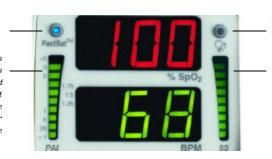
Der Alarm Status Indikator blinkt im Falle eines Alarmereignisses.
