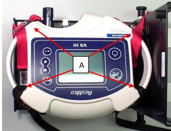
A) alle 4 Gurte müssen durch die Handgriffe geführt werden, geschlossen und Richtung Bodenplatte **festgezogen** werden.
