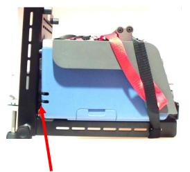
Das Gerät bündig an die Rückwand stellen; vorne bleibt ein Freiraum
