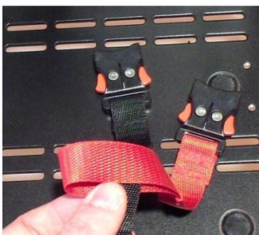
roten Gurt mit Kupplung über schwarzen Gurt mit Kupplung führen (siehe Bild)
