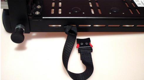
Schwarzer Gurt mit Kupplung, 2. Loch ab Rückwand an der Geräteseite
