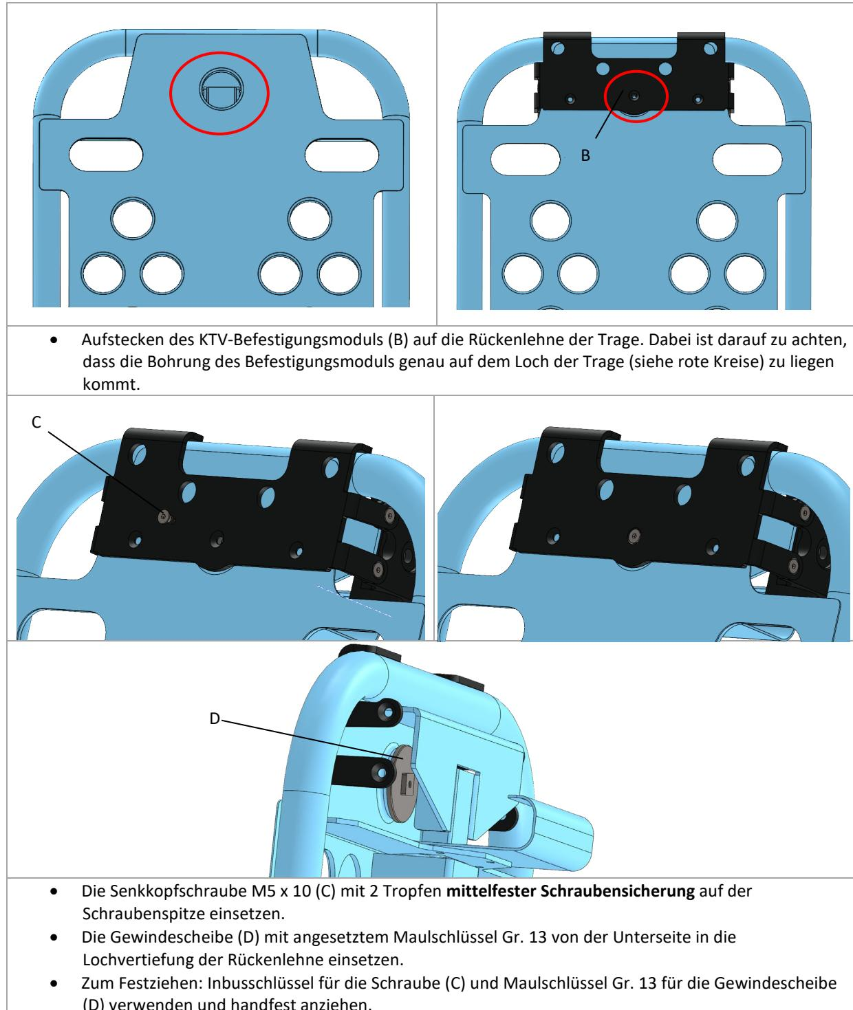
Montageschritt 2: Montage des KTV-Gestänges am KTV-Befestigungsmodul
