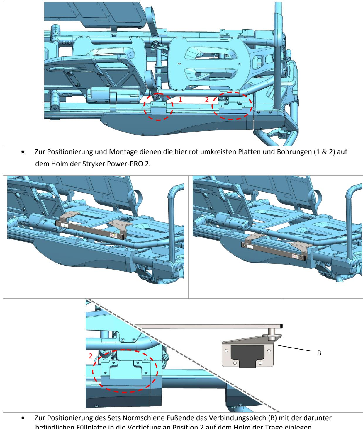
Montageschritt 2: Montage des Sets Normschiene Fußende an der Trage
