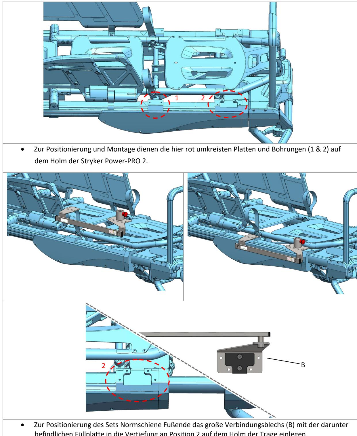
Montageschritt 2: Montage des Sets Normschiene Fußende an der Trage
