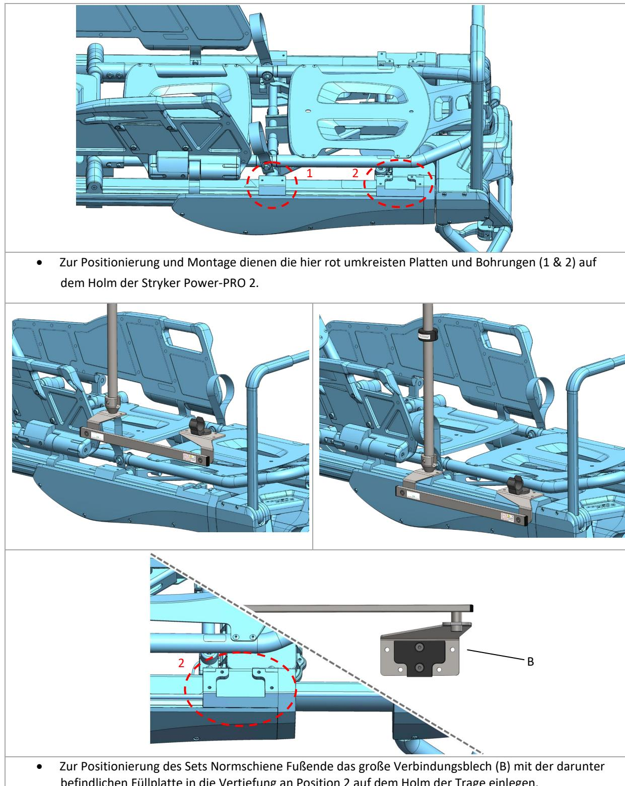
Montageschritt 3: Montage des Sets Normschiene Fußende an der Trage
